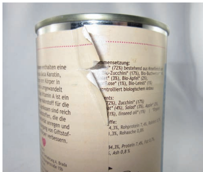
Unsaubere Arbeit: Bei mehreren Dosen verdeckte der Klebefalz Teile der Kennzeichnung.
